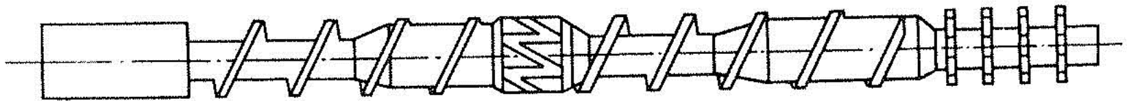
4-ro strefowy ślimak z elementem ścinającym i częścią mieszającą dla wylączarki z odgazowaniem
