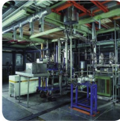
Pilotażowa instalacja 23 kg/h firmy Sulzer w Szwajcarii wykorzystująca nowy monomer laktydowy firmy Purac
