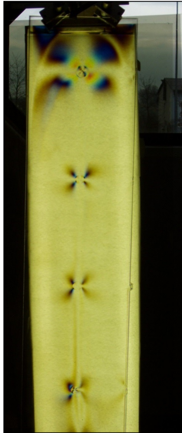
Wtryskiwanie z doprasowaniem: Mała siła zwarcia Małe naprężenia
