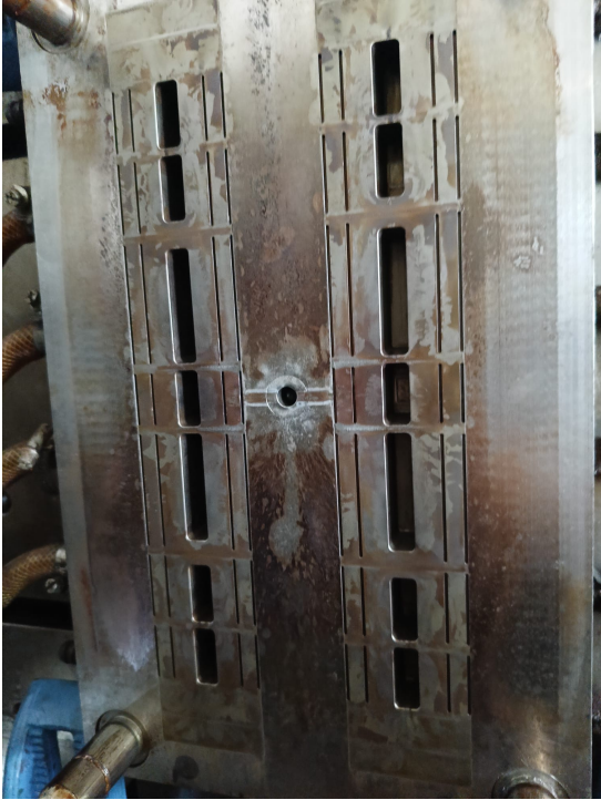
Forma przed czyszczeniem
