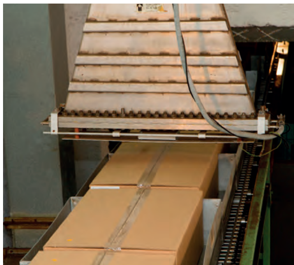
Ryc. 1 Radiacyjnie sterylizowane kartony ze sprzętem medycznym pod skanerem wiązki elektronów akceleratora Elektronika 10/10 w IChTJ
